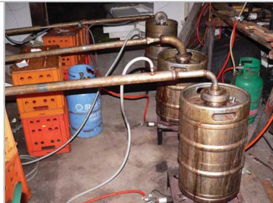
Recipientes de reacción de 20 litros (izquierda) y de 50 litros (derecha) de capacidad utilizados en el proceso de destilación en instalaciones clandestinas de elaboración de anfetamina desmanteladas en Kobytko (2002) y Puchaty (2008), respectivamente, las dos en Polonia. Fuente: Oficina Central de Investigación. Cuartel General de la Policía Nacional en Varsovia [Central Bureau of Investigation, National Police Headquarters Warsaw].
